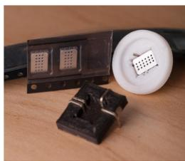
Abb. 2: MiCS-2714 (links) und MiCS-4514 (rechts) in 3D-gedrucktem und selbst entwickeltem Adapter
