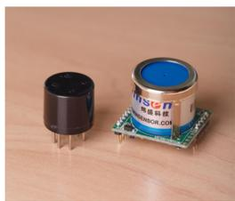
Abb. 1: MQ131 (low concentration) (links) und ZE15-CO (rechts)
