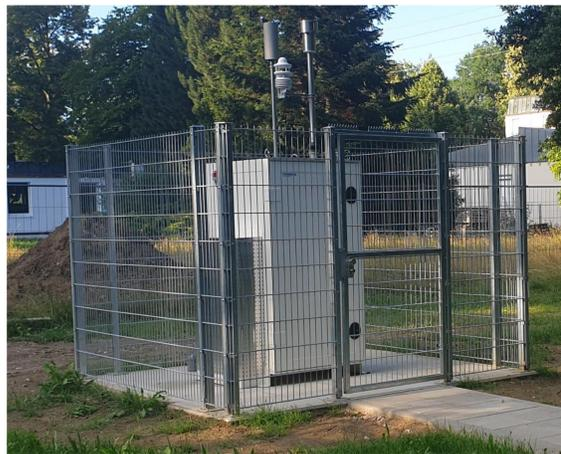
Abb. 7: Luftmessstation der Professur für regionalen Klimawandel und Gesundheit für Luftschadstoffe und meteorologische Parameter am Universitätsklinikum Augsburg. Die atmospheric exposure monitoring station (AEMS) dient zur Luftqualitätsmessung direkt in der Patientenumgebung und zur Kalibrierung der AELCM-Boxen.
