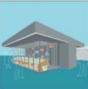
Für die kalte Jahreszeit sowie zum Feierabend kann der Stand vollständig mit Schiebelementen geschlossen werden. Aufgrund der raumhohen Verglasung bleibt die Auslage weitgehend sichtbar. Ein Teil der Elemente besitzen manuelle Hebe-Schiebe-Öffnungen für den Verkauf im Winter.
