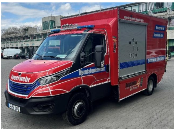
Abbildung 36: Elektrisches Kleinalarmfahrzeug eKIAF der Berufsfeuerwehr Augsburg.
