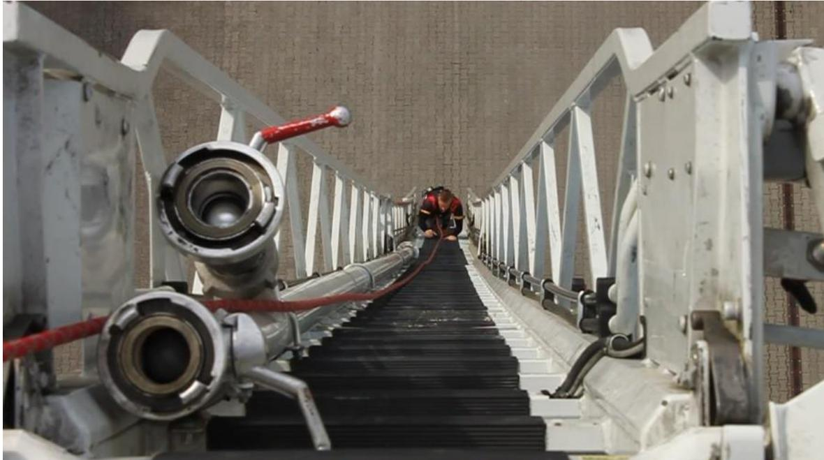
Sicheres und schnelles Besteigen einer Drehleiter die auf eine Höhe von 30 Metern ausgefahren ist und einen Aufrichtwinkel von 75 ° aufweist.
