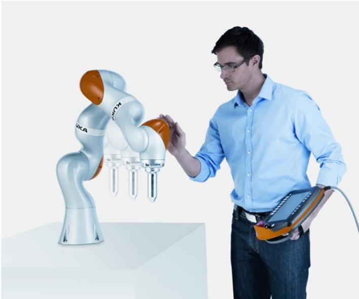
*Der sensitive Leichtbauroboter LBR iiwa kann dank innovativer Technologien sicher mit dem Menschen zusammenarbeiten. Das schafft neue Einsatzbereiche für die roboterbasierte Automatisierung.*
