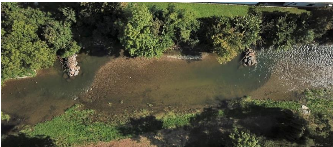
Abbildung 30: Bühnen als Instream-Strukturgeber, bei entsprechendem Abstand bilden sich Kolk-Furt-Abfolgen im Gerinne, gewässerökologisch wertvolle Strukturen entstehen (Foto: Martin Mühlbauer, ezb)
