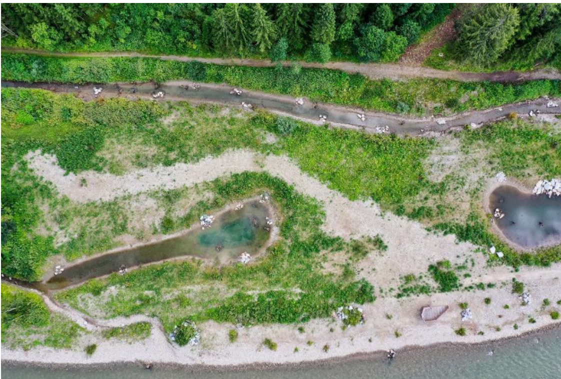
Abbildung 32: Strukturierungsmaßnahmen an der Möll in Obervellach: Nebenarm, Altarm mit Tiefstelle und Stillgewässer (Fotos: Revital)
