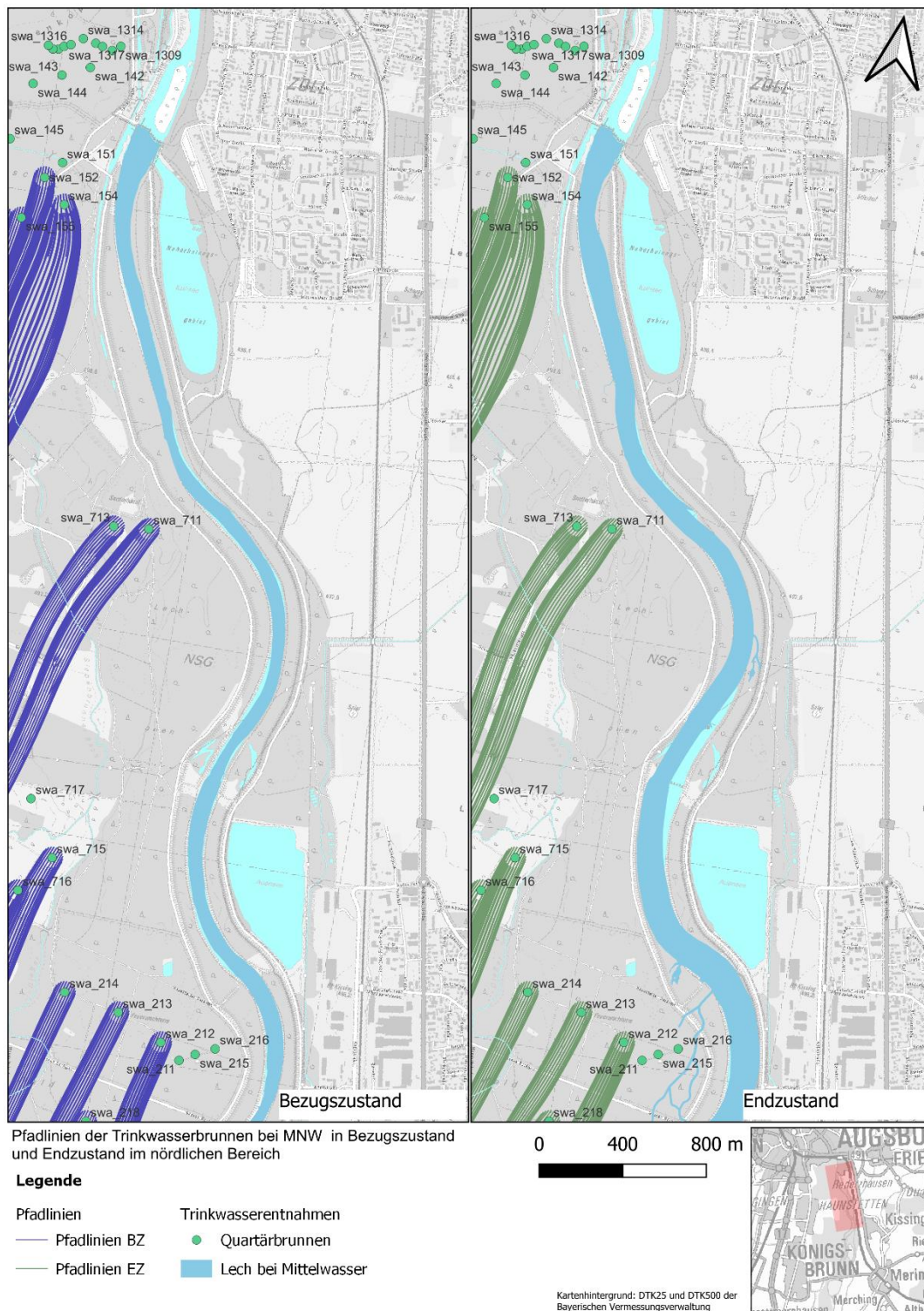
Abbildung 8.8: Stromlinien der Trinkwasserbrunnen im Bezugs- und Endzustand bei MNW / Bereich Nord
