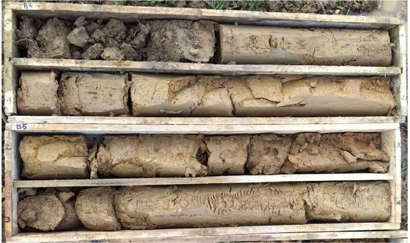
Bohrkern B 5 4,0 - 8,0 m:
