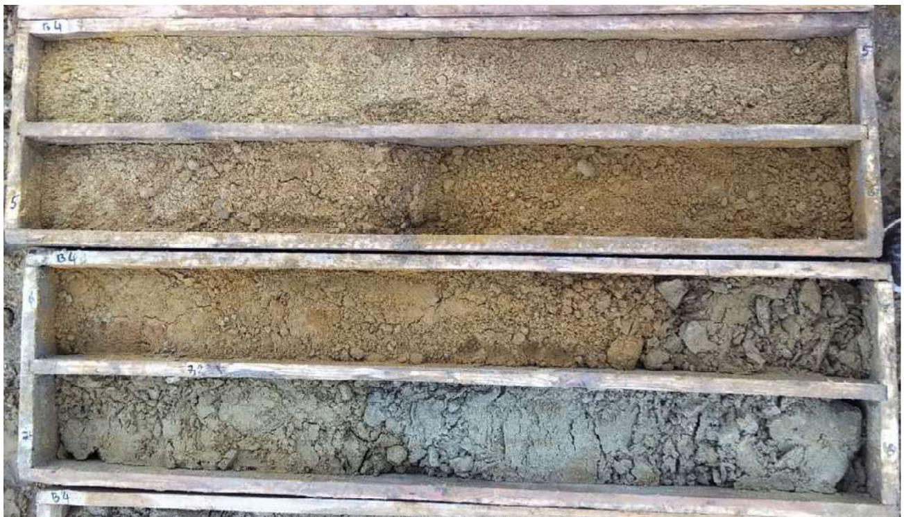
Bohrkern B 4 8,0 - 10,0 m:
