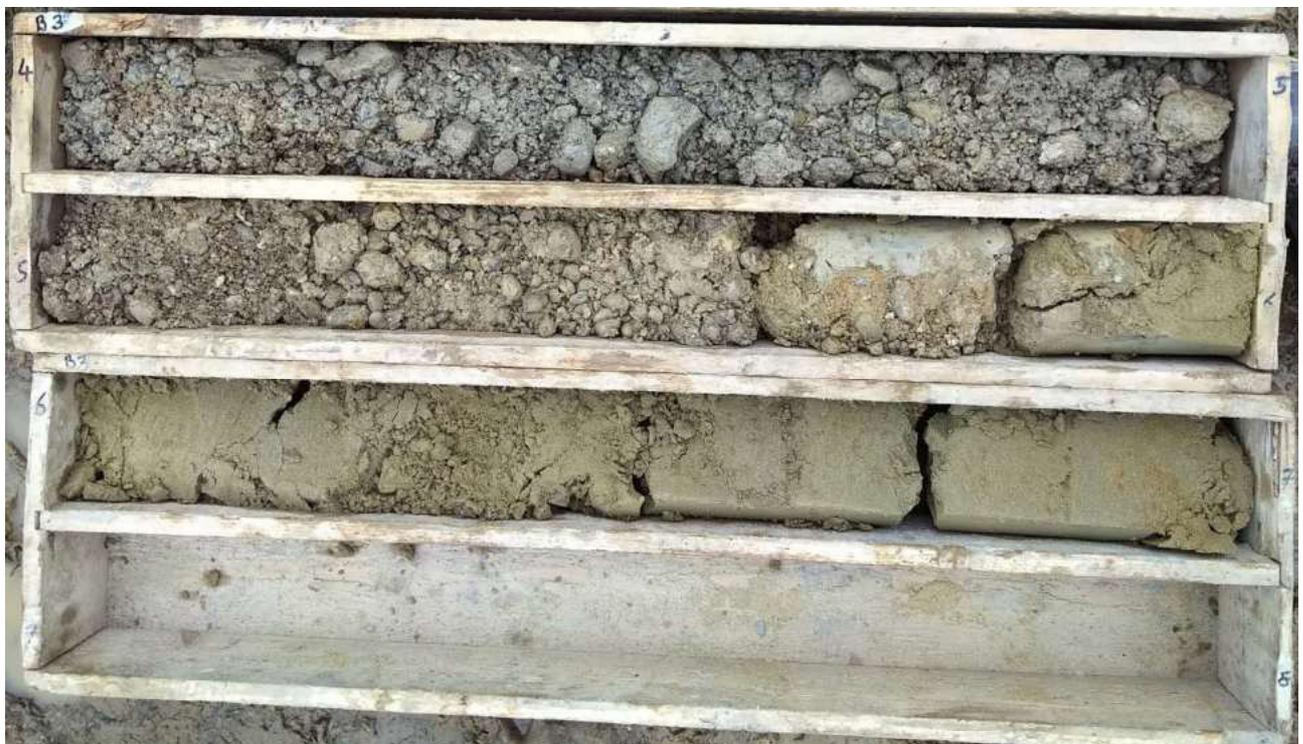
Bohrkern B 4 0,0 - 4,0 m:
