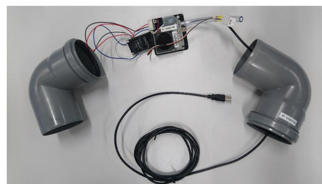
Abb. 3: Fertiges Sensormodul samt Gehäuse als Witterungsschutz
