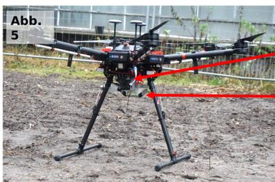
**Abb. 5: Copter (M600 Pro) mit Messsensorik**
