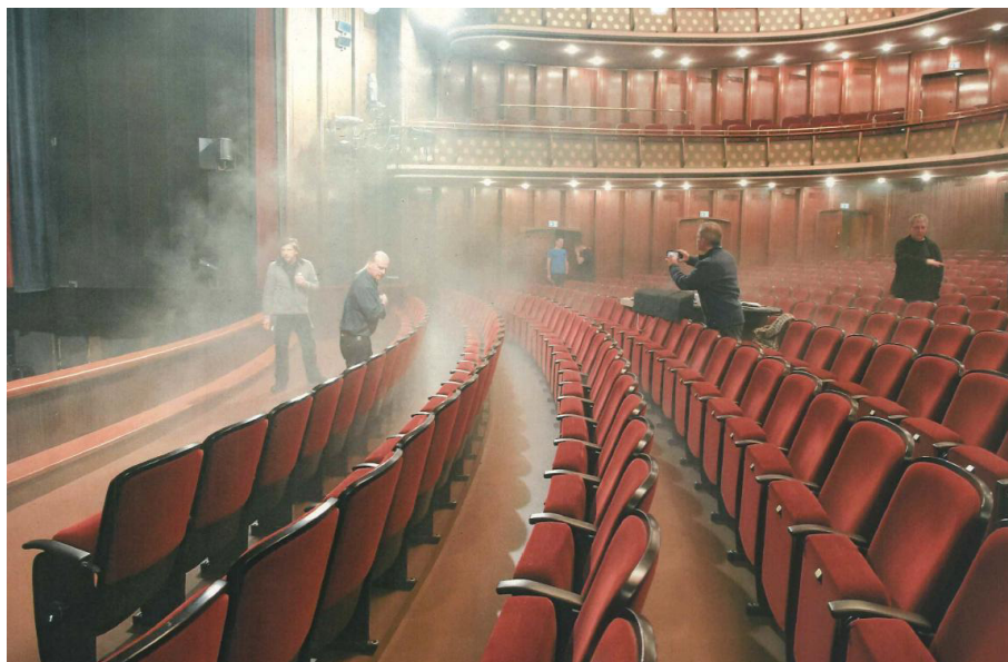
Abbildung 1: Rauchverschleppung in den Zuschauerraum ([u5])
